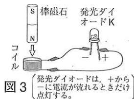
図3 発光ダイオードは, 十から一に電流が流れるときだけ点灯する。
