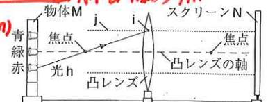
図7 { 2本の破線(-----)は, 凸レンズの軸と平行で, 凸レンズの軸との距離が同じである。光hは, 点iで破線jと交わっている。
